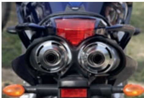
Naast de retroreflector in het lichtarmatuur (de houder van de lamp) zit er achterop de motorfiets vaak ook nog een aparte rode retroreflector.
